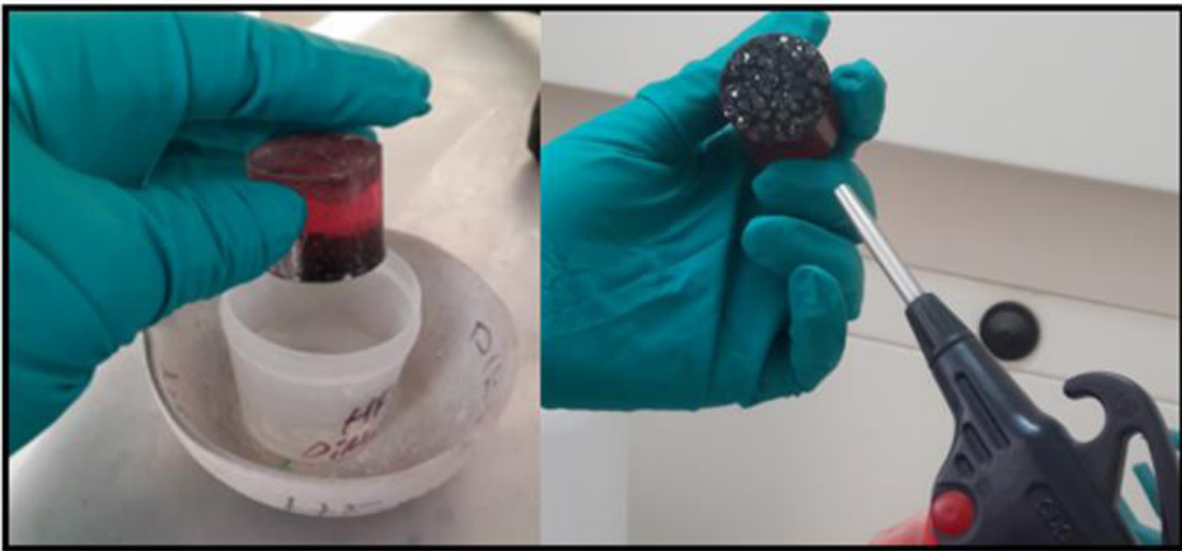
Şekil 26. HF asit yardımıyla yüzeyin dağlanması
