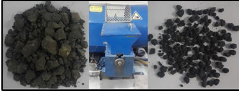
Şekil 20. Tane boyutu kırıcı yardımı ile küçültülen klinker granülleri
