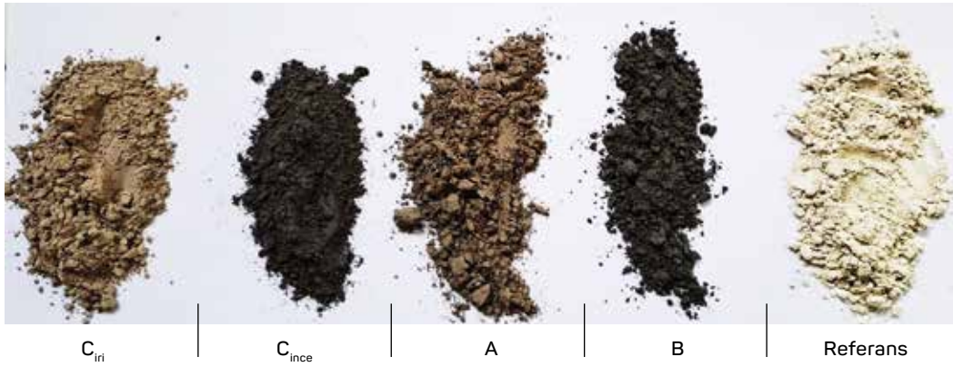
Şekil 1: Döküm tesislerinden temin edilen ADK'nın öğütme sonrası toz haldeki görselleri Figure 1: Visuals of WFS obtained from casting facilities in powder form after grinding
