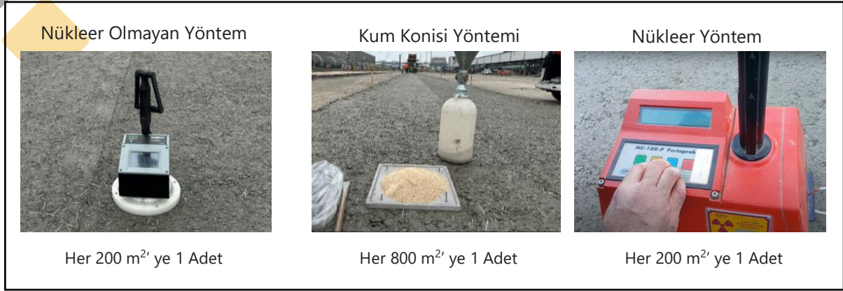
Şekil 3: Sıkışma Ölçüm Yöntemleri
