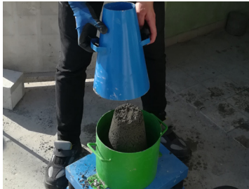
Şekil 1: VeBe Kıvam Deneyi
