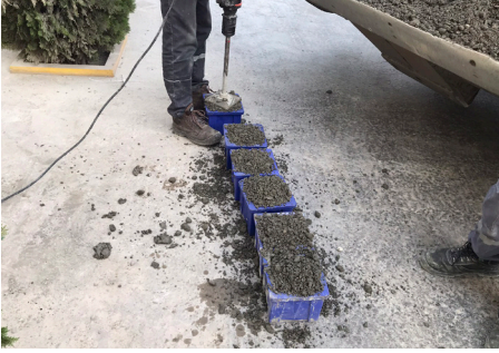
Şekil 2: SSB Küp Numuneler
