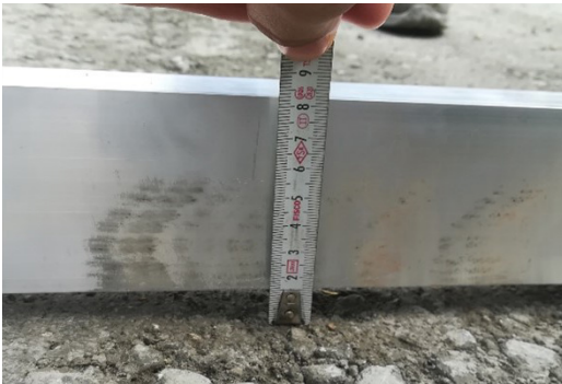
Şekil 5: Masterla Yüzey Düzgünsüzlük Kontrolü
