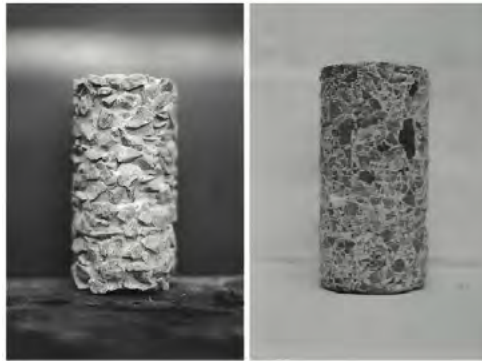
Şekil 4. Sülfürik asitle muamele edilmiş laboratuvar beton numuneleri [36]
