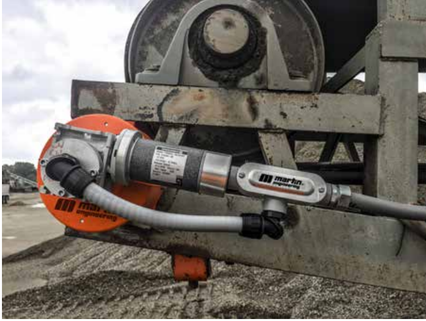
Otomatik gergi, operatör müdahalesi olmadan optimum temizleme basıncını korur. / Automatic tensioner maintains optimum cleaning pressure without operator intervention.
