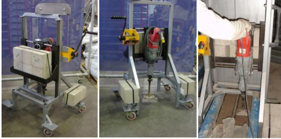
Şekil 3. SSB kiriş numunelerinin laboratuvar ortamında üretilmesi için çalışmacılara özgü geliştirilen sıkıştırma ekipmanı Figure 3. Some compaction tools special/unique to researchers to prepare RCC beam specimen in laboratory [8].
