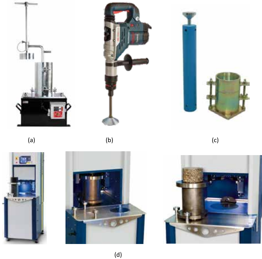
Şekil 2. Laboratuvar koşullarında SSB üretimi için kullanılan başlıca sıkıştırma ekipmanları (a) Sarsma tablası 1 (b) Titreşimli tokmak 2 (c) Modifiye proktor 3 (d) Superpave yoğurtmalı sıkıştırmacı 4
