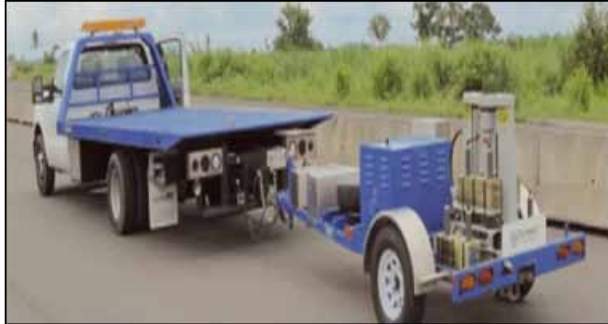
Şekil 6: Üstyapı rijitliklerini belirlemek için kullanılan Düşen Ağırlıklı Deflektometre Figure 6: Falling weight deflectometer to evaluate pavement rigidity
