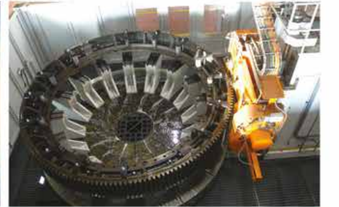
7m. Çap Diş Açma Tezgahı - Hobbing Machine
